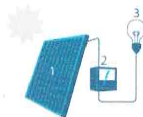
1 Zonnepaneel 2 Omvormer 3 Lichtbron
